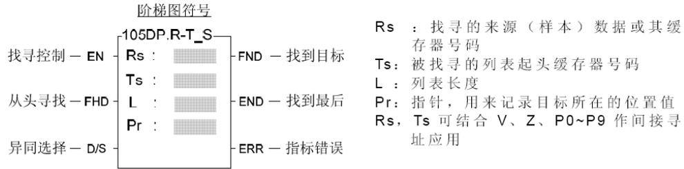
当找寻控制“EN”=1 或“EN↑”（P指令）由0→1时，自列表Ts 的开头第一个缓存器开始（“FHD”=1 或Pr值已达L=1时）或自列表中当时指针所指那个缓存器的下一个缓存器Tspr+1 开始（“FHD”=0 同时 Pr 值小于L1）往下找寻和样本数据Rs不同（D/S=1时）或相同（D/S=0 时）的缓存器。若找到（不同或相同的），则立即停止，并将该目标在列表的位置序号值存放到Pr 去，同时将找到目标旗号“FND”设为1。
