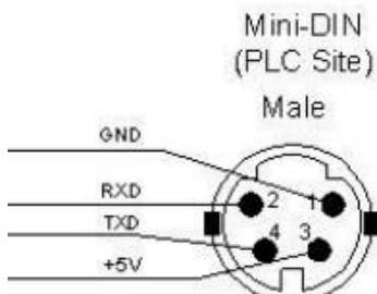
答：如图所示，正常需要 GND、RXD、TXD 这三个引脚。5V 一般可以不用接
